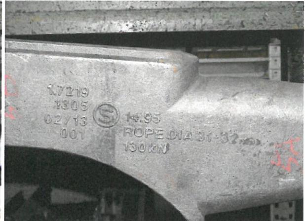
Bilder 1 bis 8 Ganzzerreissversuch nach Pulsatorversuch
